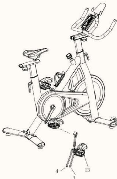
1. Identifiez les pédales gauche et droite (13) en repérant les lettres gravées "L" pour Left (gauche) et "R" pour Right (droite).
